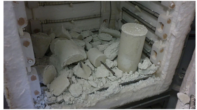
Figura 1. Rotura explosiva en un hormigón convencional durante el calentamiento.
