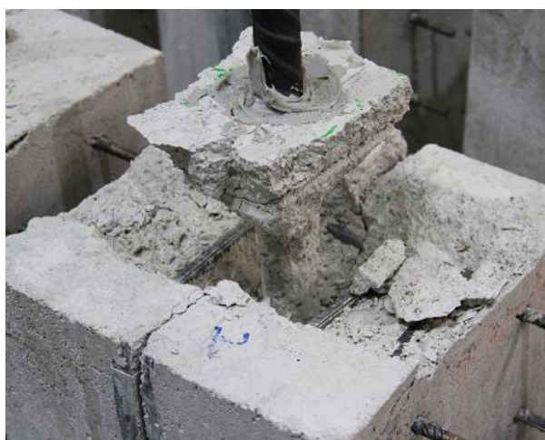
Figura 16: Probeta rota en ensayo de tracción.
