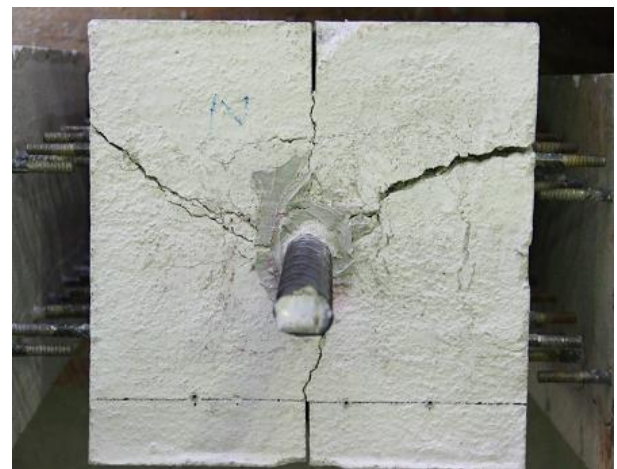
Figura 18: Probeta ensayada a cortante
