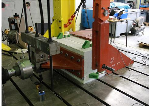
Figura 17: Montaje del ensayo de cortante
