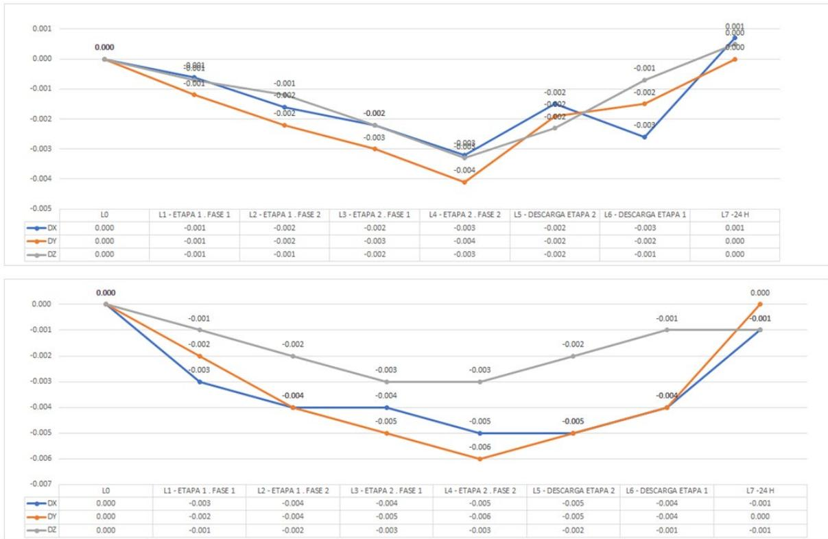
Figura 31. Desplazamientos en pila, lado Norte y Sur (mm)
