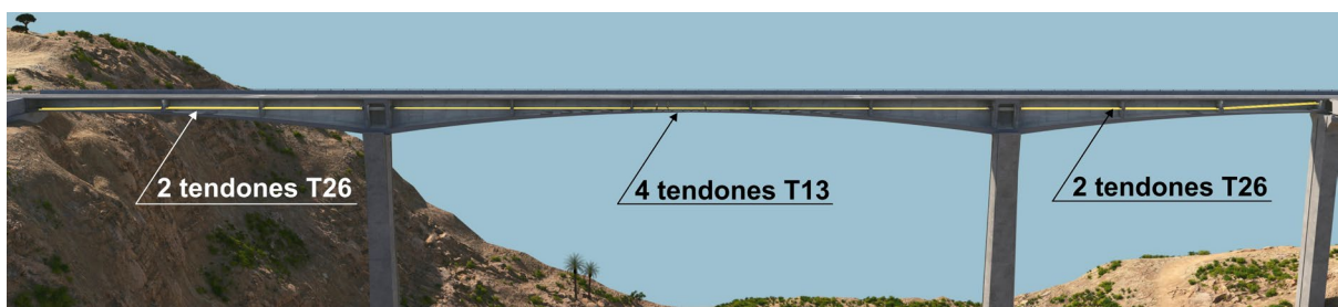
Figura 10. Esquema del pretensado exterior complementario de refuerzo
