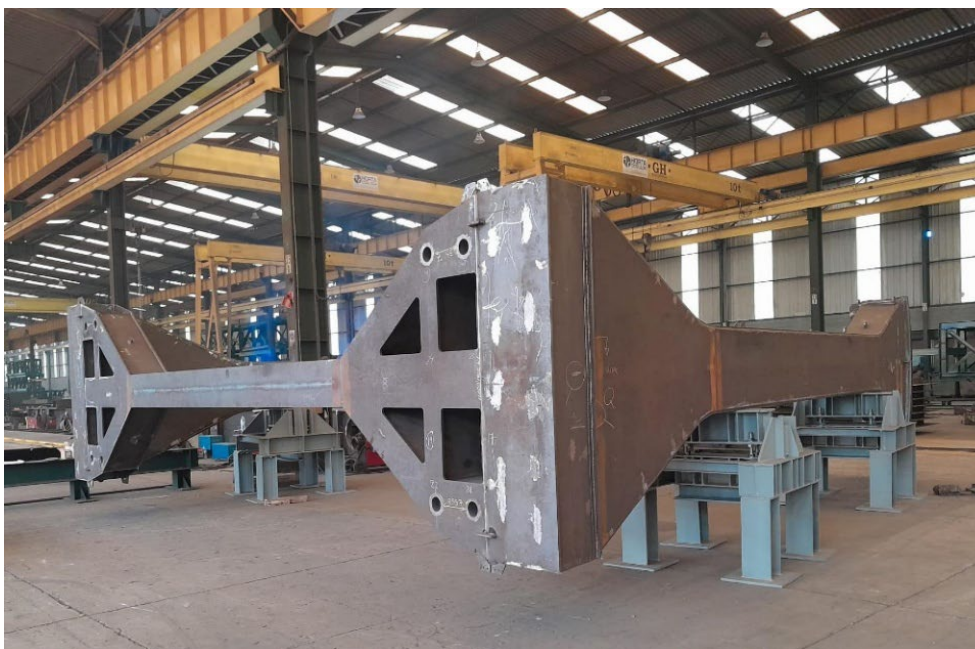
Figura 25. Montaje en blanco de la pieza metálica en taller
