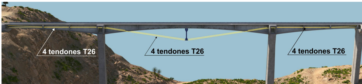
Figura 18. Esquema del pretensado complementario de refuerzo
