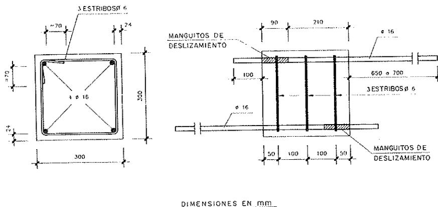
Fig. 2: Probetas de la Serie II (tipo 2)
