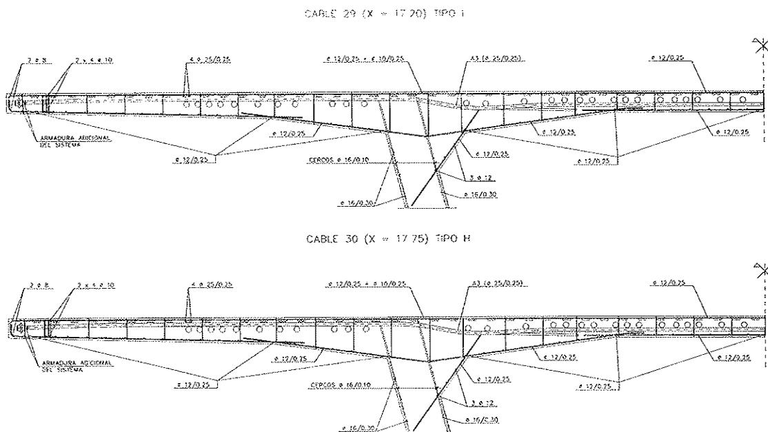
Fig. 5. Sección longitudinal cable de pretensado transversal.
