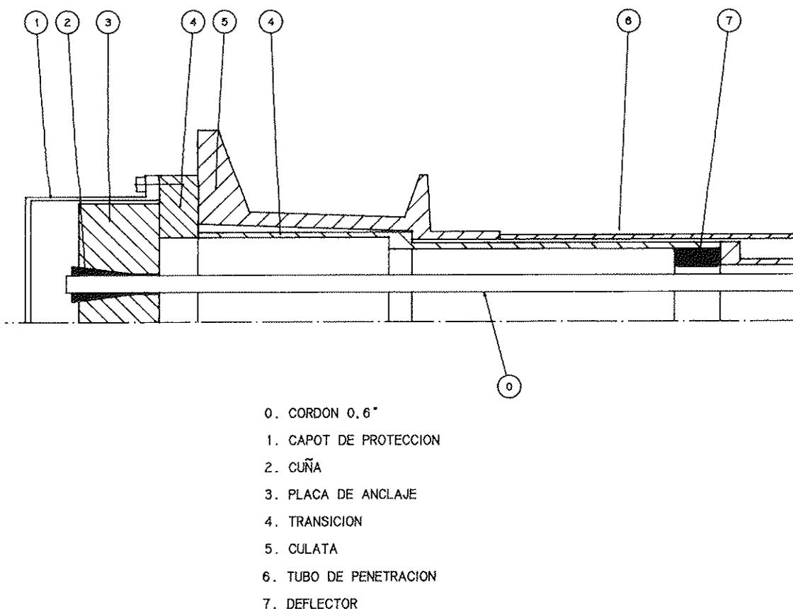
Figura 3. Esquema del anclaje activo sustituible Stronghold.
