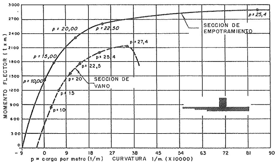
Fig. 12. Diagrama momento-curvatura para la sección propuesta.
