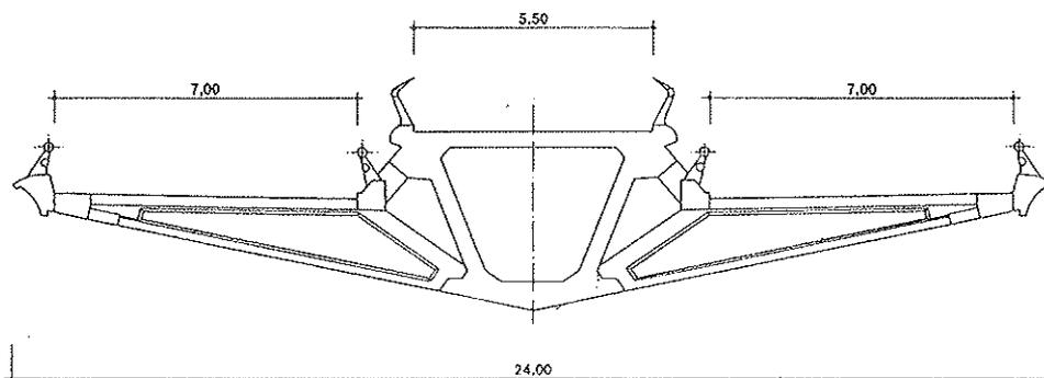
Fig. 2. Sección transversal.
