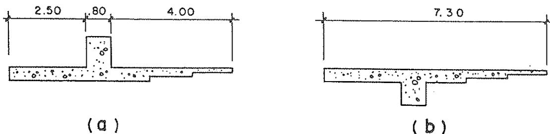
Fig. 11. A) Geometría proyectada. B) Geometría invertida.
