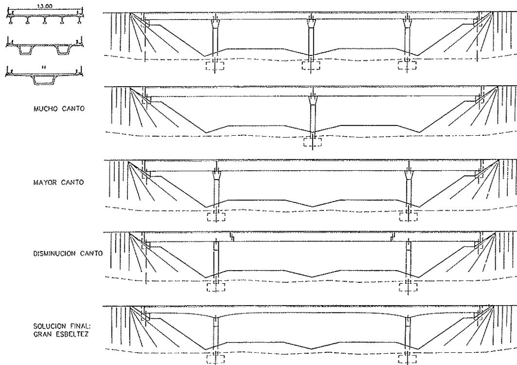
Figura 1. Evolución de los pasos superiores prefabricados.
