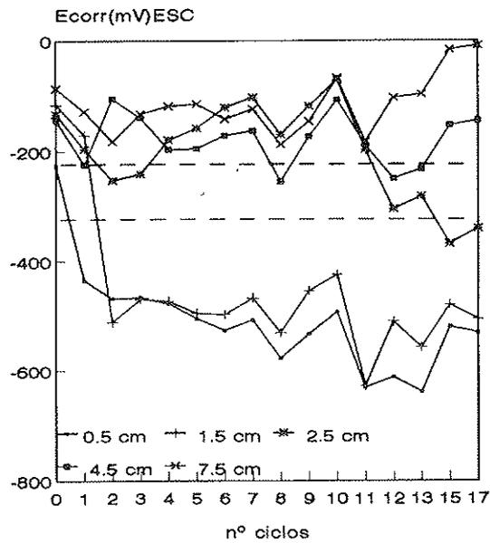
Fig. 2. Evolución del potencial de corrosión ( $E_{corr}$ ) para los ciclos de inmersión/secado a distintas profundidades de la armadura y para los 3 porcentajes de adición: (a) 0%, (b) 15% y (c) 35%.
