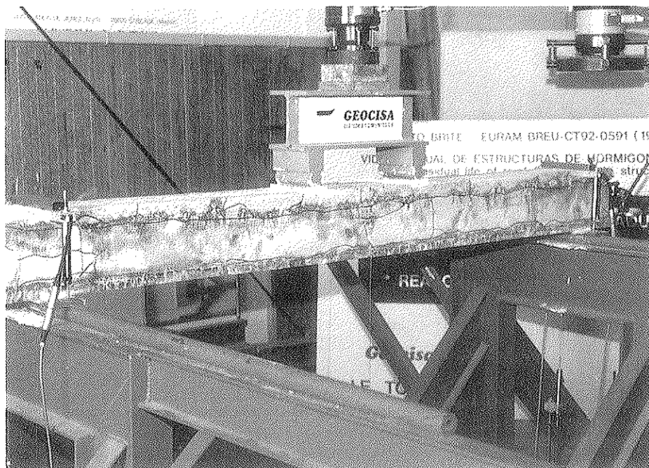
Figura 6. Vista del ensayo de carga de una viga con armaduras corroídas.
