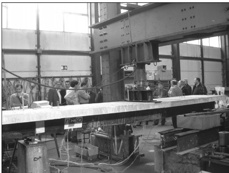
Foto 4. Ensayo de la viga sólo de carbono.
