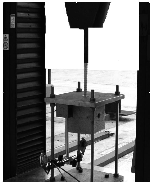
Figura 6. Ensayo de adherencia.
