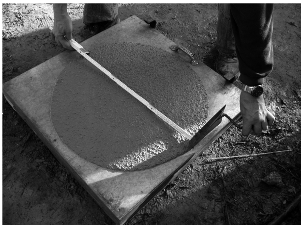
Figura 17. Ensayo de escurrimiento.
