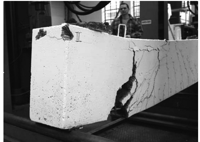
Figura 10. Ensayo con una viga de hormigón infraligero.
