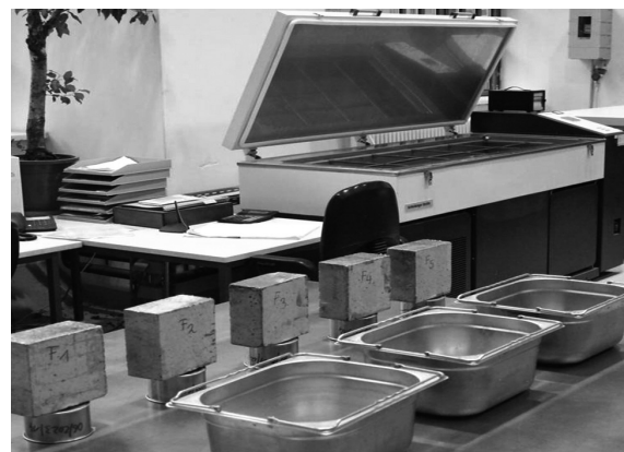
Figura 16. Ensayo de heladicidad.
