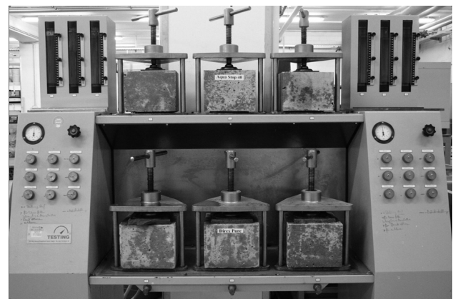
Figura 15. Ensayo de permeabilidad.
